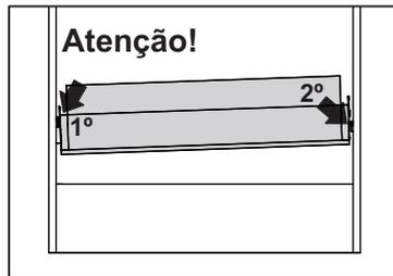
Para encaixar o estrado na estrutura é importante posicionar ele na diagonal, como mostra a imagem acima, encaixando primeiro o rolamento do lado esquerdo e depois o rolamento do lado direito. Após encaixe o pistão conforme mostra a imagem ao lado.
