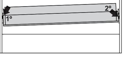
Para encaixar o estrado na estrutura é importante posicionar ele na diagonal, como mostra a imagem acima, encaixando primeiro o rolamento do lado esquerdo e depois o rolamento do lado direito. Após encaixe o pistão conforme mostra a imagem ao lado.
