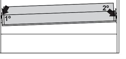
Para encaixar o estrado na estrutura é importante posicionar ele na diagonal, como mostra a imagem acima, encaixando primeiro o rolamento do lado esquerdo e depois o rolamento do lado direito. Após encaixe o pistão conforme mostra a imagem ao lado.
