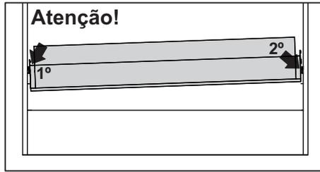
Para encaixar o estrado na estrutura é importante posicionar ele na diagonal, como mostra a imagem acima, encaixando primeiro o rolamento do lado esquerdo e depois o rolamento do lado direito. Após encaixe o pistão conforme mostra a imagem ao lado.
