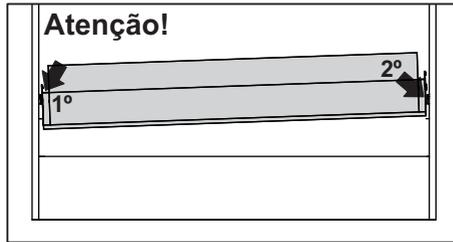
Para encaixar o estrado na estrutura é importante posicionar ele na diagonal, como mostra a imagem acima, encaixando primeiro o rolamento do lado esquerdo e depois o rolamento do lado direito. Após encaixe o pistão conforme mostra a imagem ao lado.
